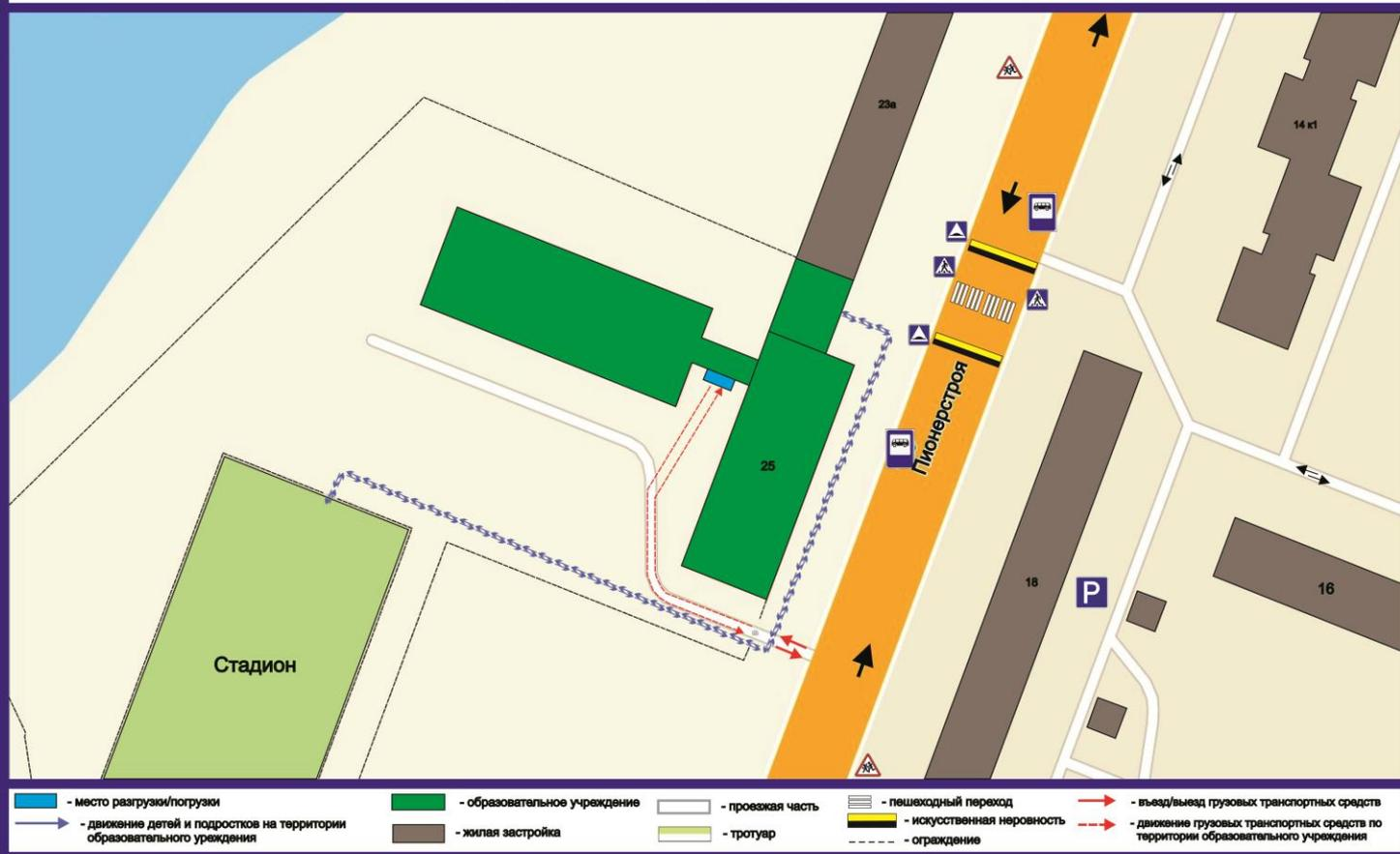
**Е. План - схема «Пути движения транспортных средств и детей при проведении дорожных ремонтно-строительных работ вблизи образовательной организации»**
